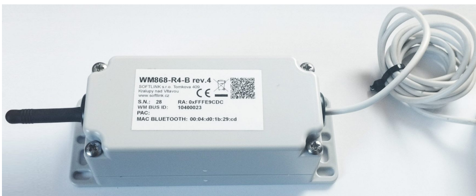
Obr. 13: Pohled na modul WM868-R4-B s připojenou anténou a zařízením RS-485
