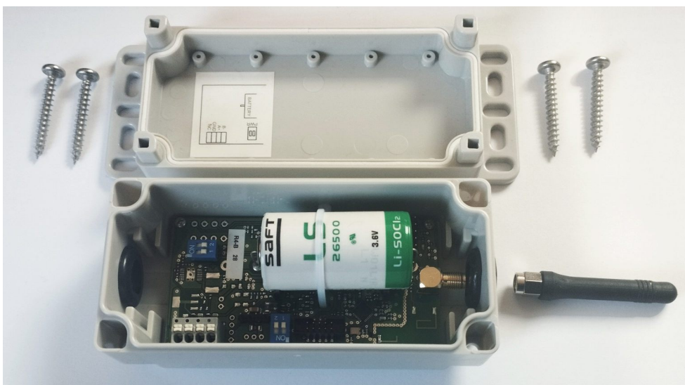
Obr. 11: Sestava modulu WM868-R4-B s tyčkovou anténkou
