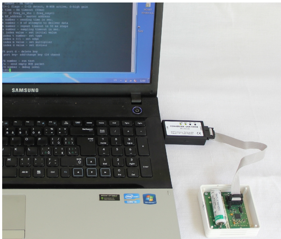
Obr. 4: Konfigurace modulu přes USB port počítače
