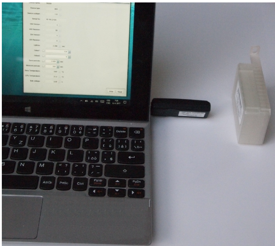
Obr. 7: Konfigurace modulu přes optický převodník
