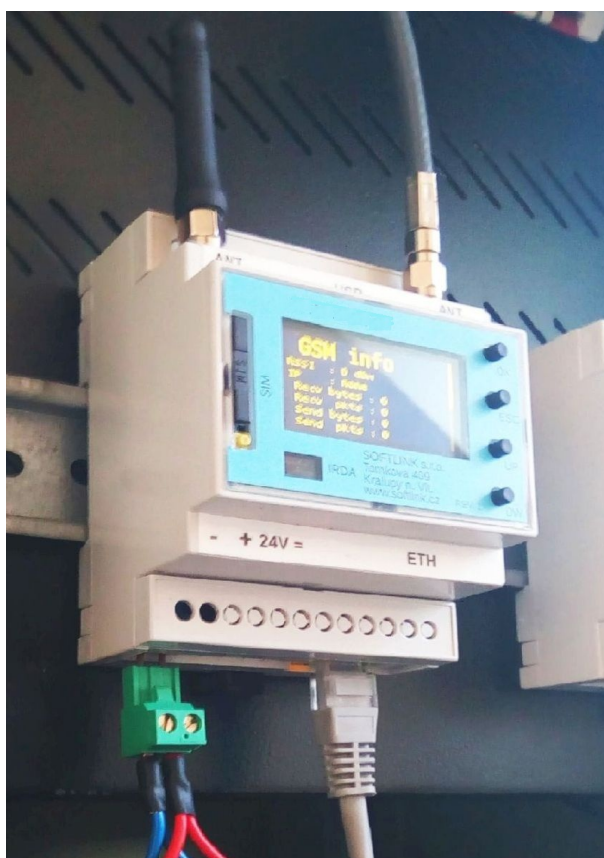
Obr. 9: Pohled na nainstalovaný modul WL868-RFG
