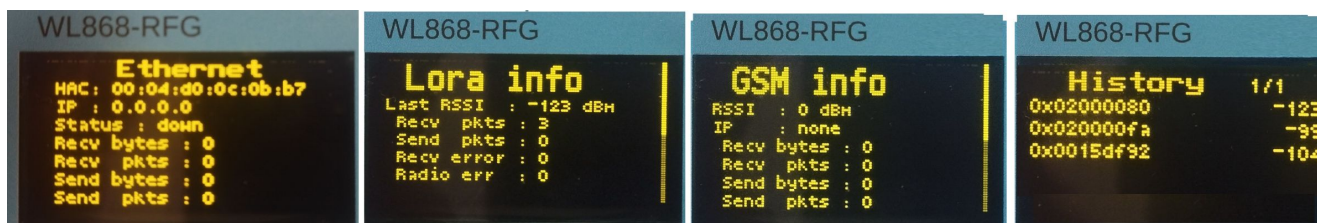
Obr. 6: Náhled zobrazení položek menu Ethernet, LoRa, GSM a Historie
