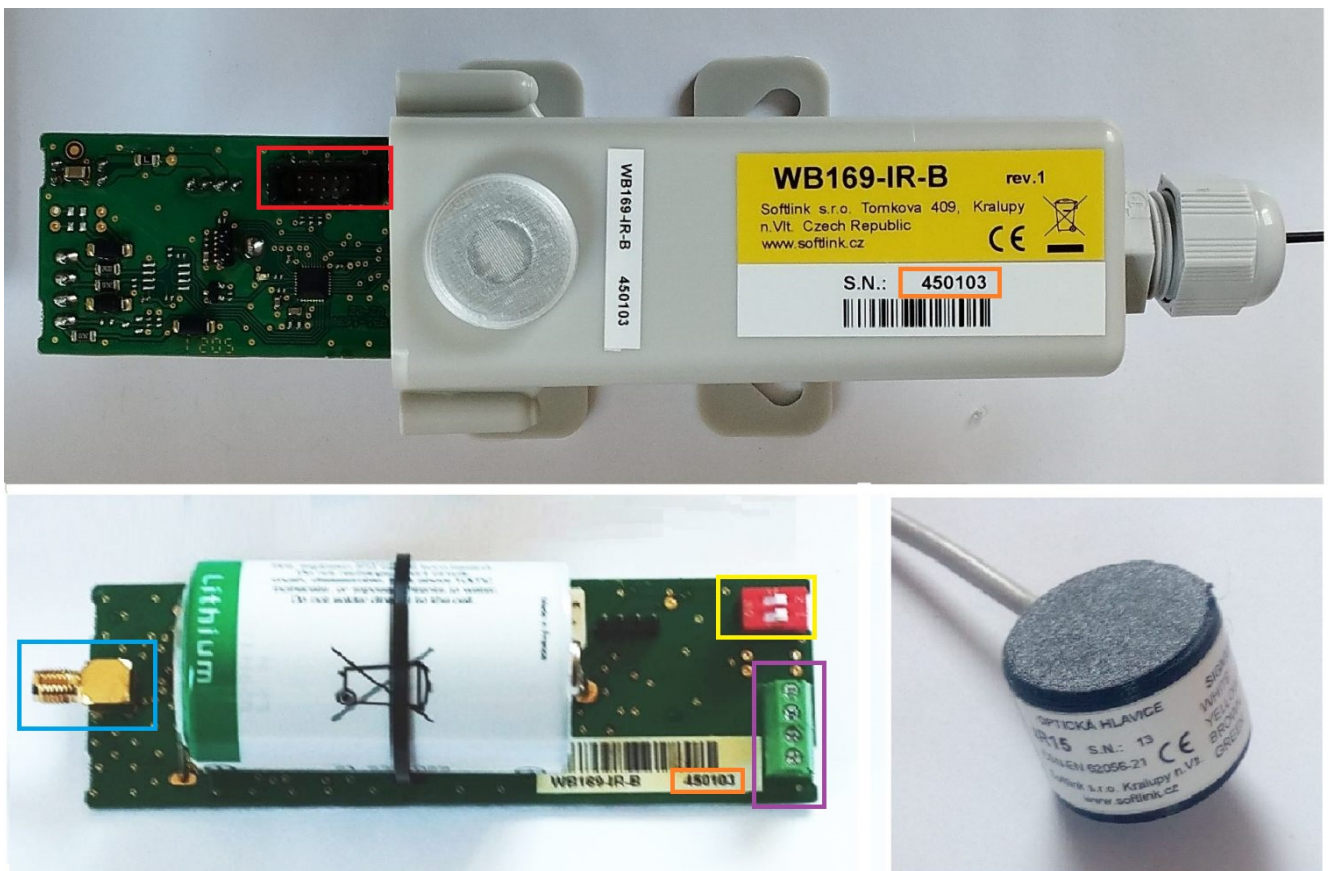
Obr. 11: Detail desky plošného spoje modulu WB169-IR-B
