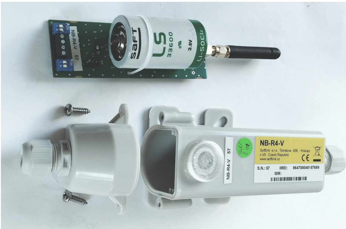
Obr. 6: Sestava modulu NB-R4-V s tyčkovou anténou
