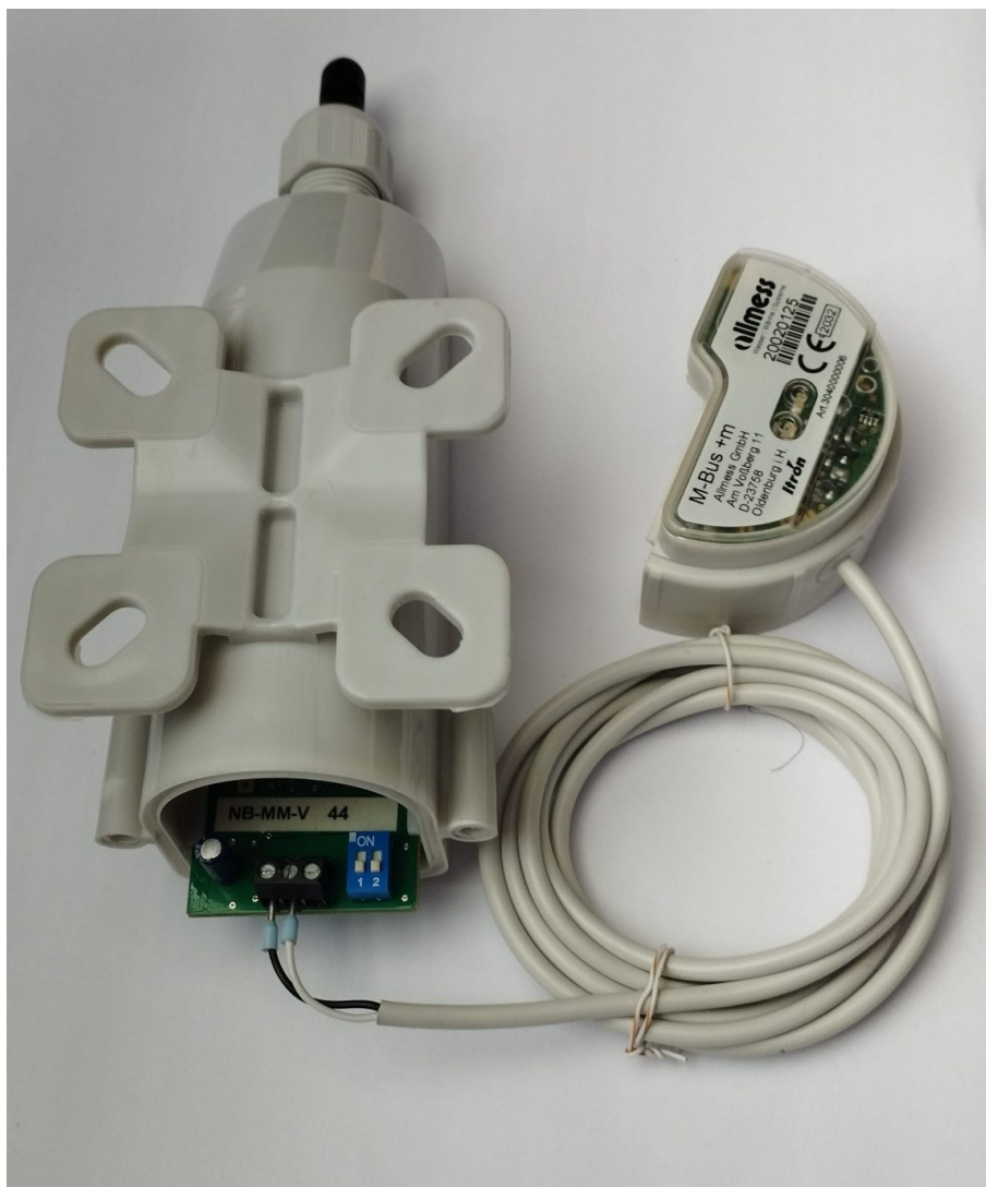
Obr. 8: Připojení měřiče s výstupem M-Bus ke svorkovnici modulu NB-MM-V
