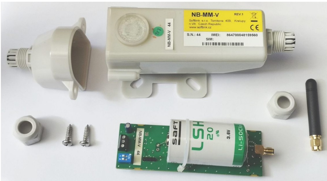
Obr. 6: Sestava modulu NB-MM-V s tyčkovou anténou
