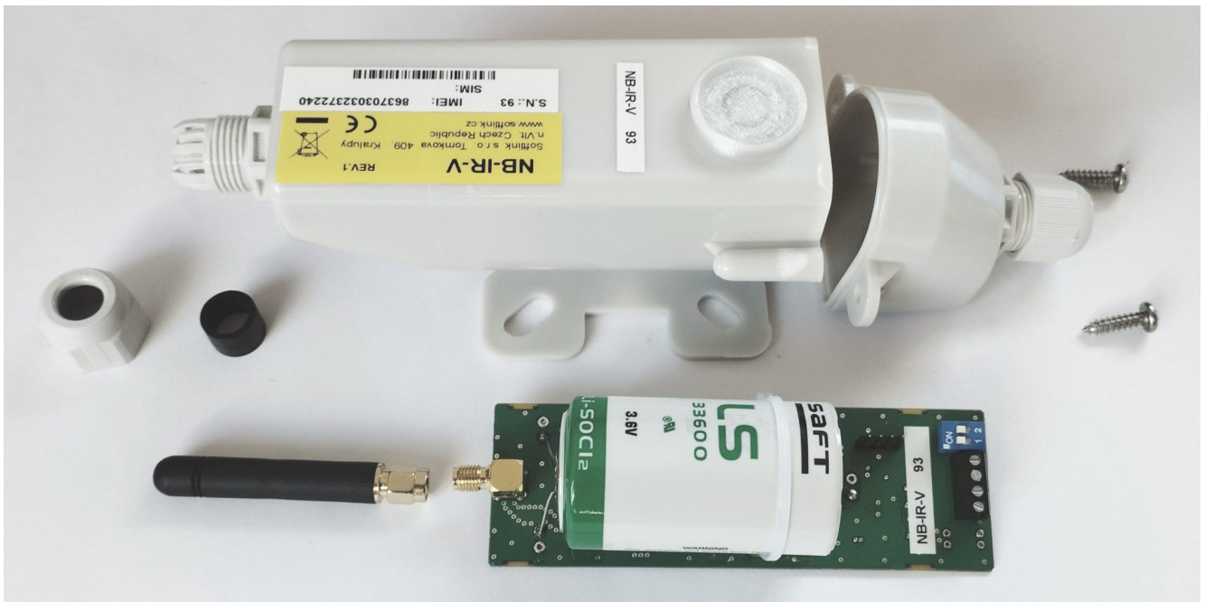
Obr. 6: Sestava modulu NB-IR-V s tyčkovou anténou
