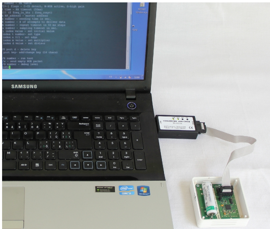
Obr. 4: Konfigurace modulu přes USB port počítače
