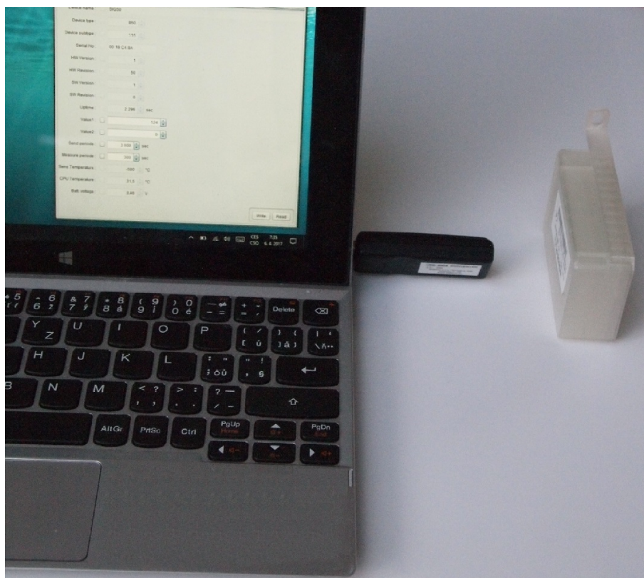
Obr. 7: Konfigurace modulu přes optický převodník
