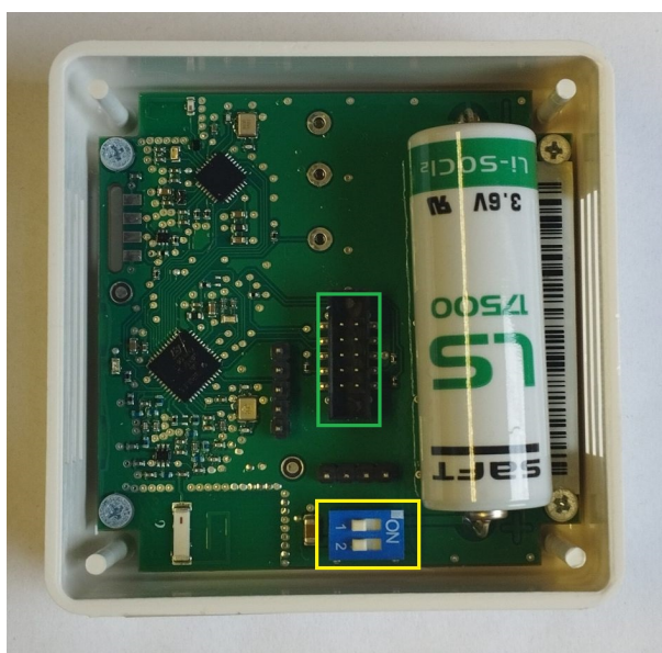
Obr. 10: Detailní pohled na modul WM868-TI4
