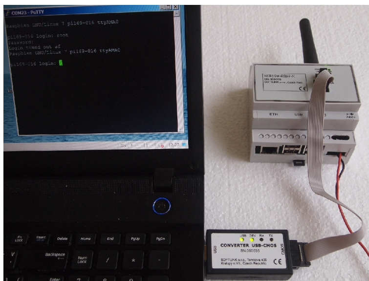
Obr. 4: Konfigurace modulu přes USB port počítače
