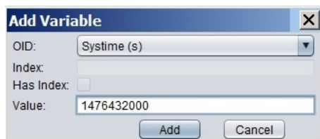
Obr. 17: Nastavení systémového času radiovou cestou
