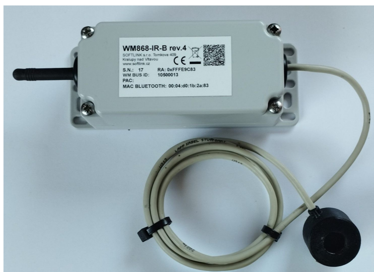
Obr. 13: Pohled na modul WM868-IR-B s připojenou anténou a optickou hlavou
