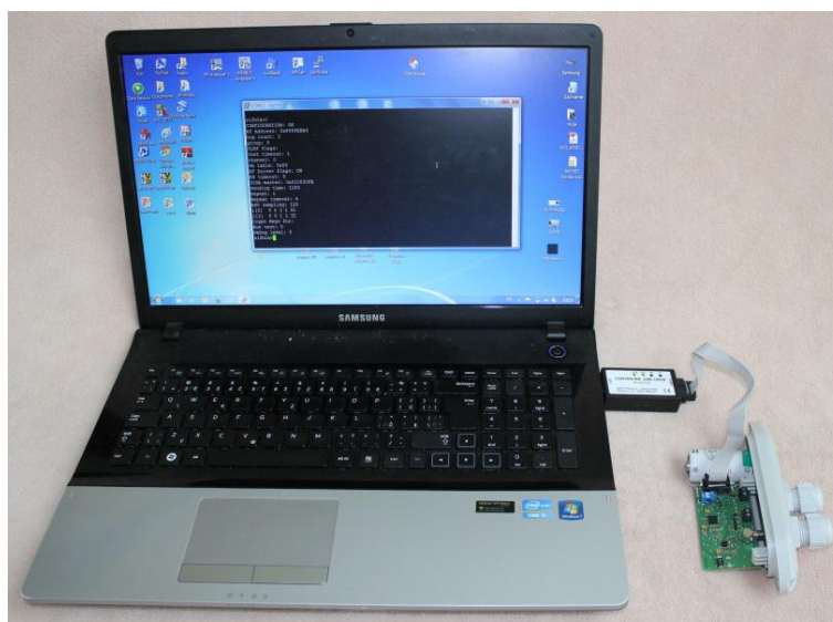
Obr. 4: Konfigurace modulu přes USB port počítače
