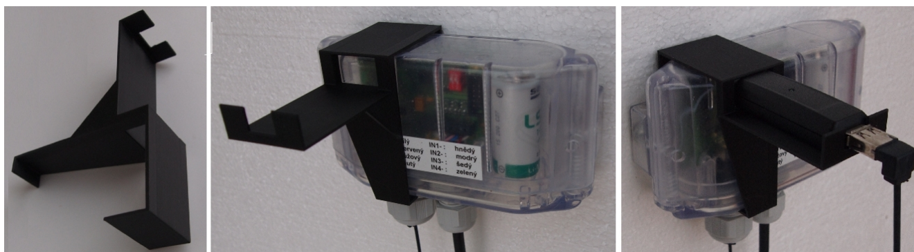
Obr. 12: Uchycení optického převodníku do přípravku
