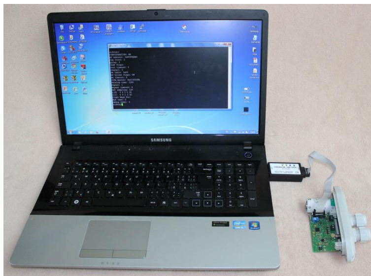
Obr. 3: Konfigurace modulu přes USB port počítače
