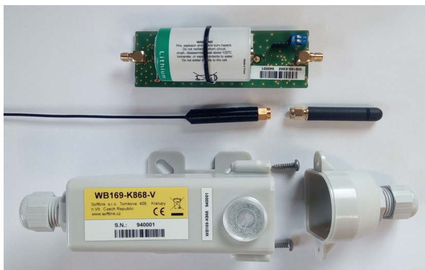
Obr. 10: Sestava modulu WB169-K868 s prutovou anténou
