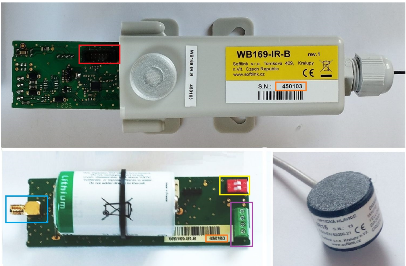
Obr. 11: Detail desky plošného spoje modulu WB169-IR-B
