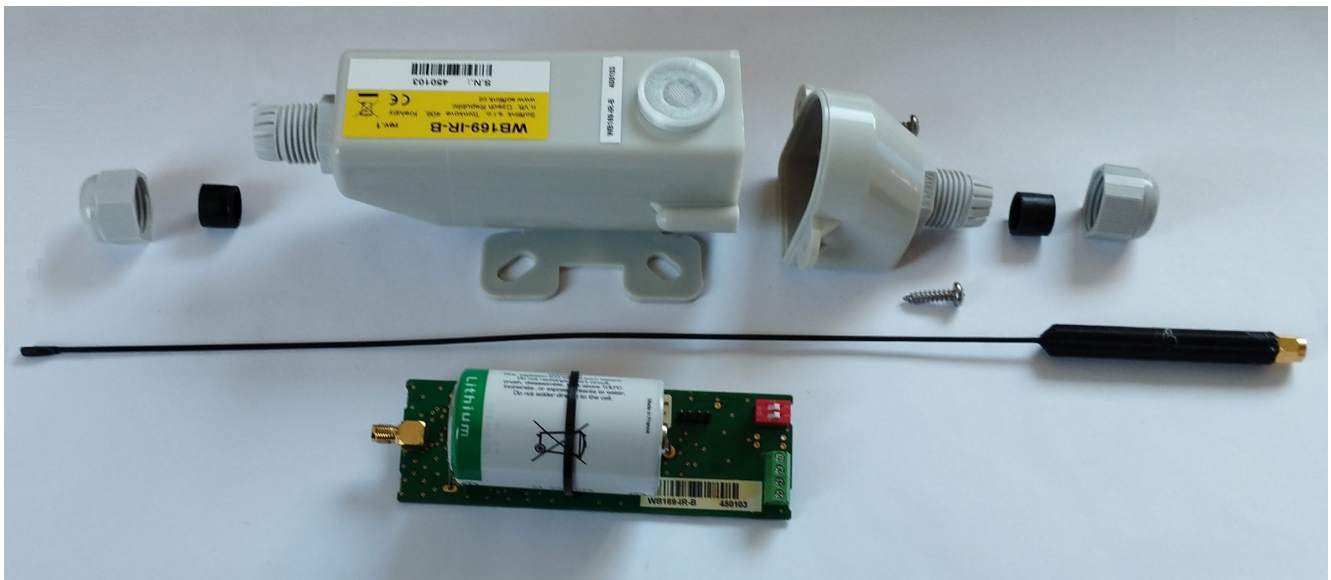
Obr. 10: Sestava modulu WB169-IR-B s prutovou anténou
