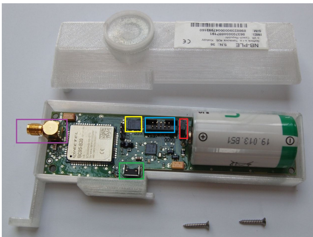
Obr. 10: Detailní pohled na modul NB-PLE
