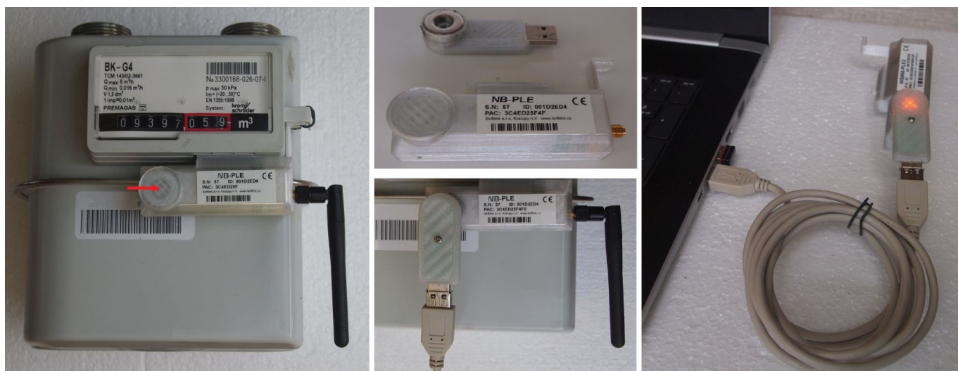
Obr. 11: Montáž a konfigurace modulu NB-PLE
