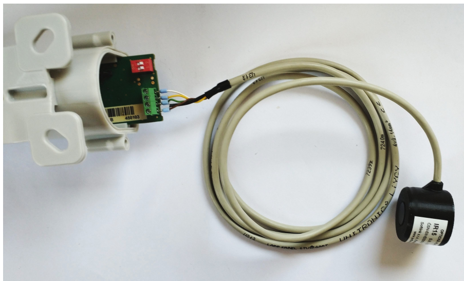
Obr. 8: Připojení optické hlavy ke svorkovnici modulu NB-IR-V
