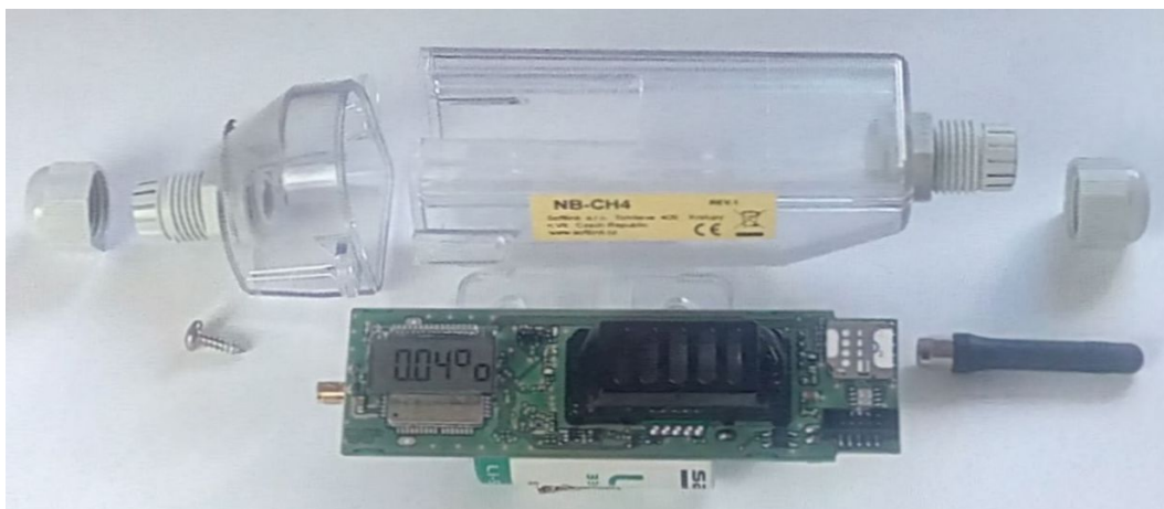
Obr. 6: Sestava modulu NB-CH4 s tyčkovou anténkou
